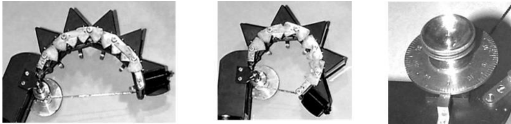
FIGURA 5. Disposició oberta o tancada per variar la dispersió. Detall de la roda amb les unitats de mesura.
